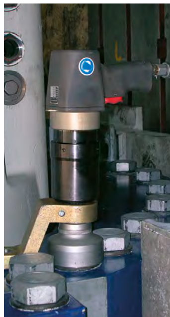
alkitronic® CLD Schraubmaschinen im Einsatz (Abbildungen rechts). Verschraubungen an einem Schraubenkranz sowie an einem Dieselaggregat für Großbaumaschinen.
