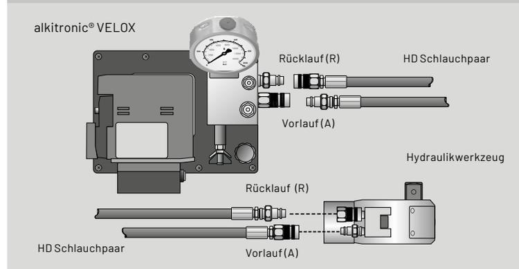
Im Lieferumfang: Hydraulikschläuche, Länge 5m (DN 6)
